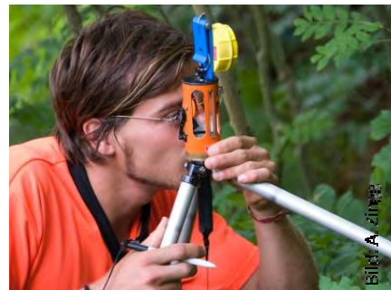
Mit dem Wessen-Kompass wird ein Baum so eingemessen, dass er auch nach Jahren wieder auffindbar ist.
